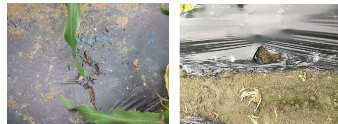
展張約3か月後 (地表部のフィルムが破れ始め、 フィルムはかなり脆くなる。)
